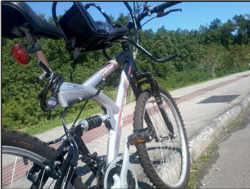
Figura 2 – “Bike meteorológica” instrumentada com sensores de temperatura, umidade relativa e pressão atmosférica.
